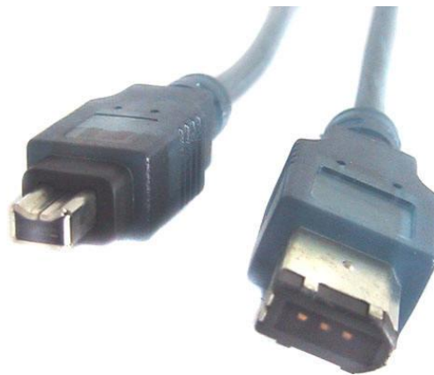
Fig. 6 - Conexão firewire de 4 e 6 conectores [8]
