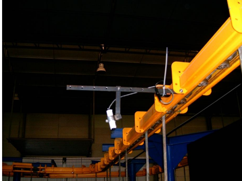
Fig. 31 - Configuração correcta do suporte do laser
